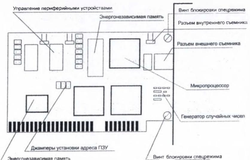
Рисунок 3.4. Плата контроллера «Аккорд 4++»
