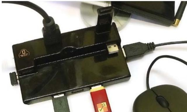
Док-станция из состава MKT-card long с подключенной периферией. В пенале для ключей - отчуждаемый микрокомпьютер
