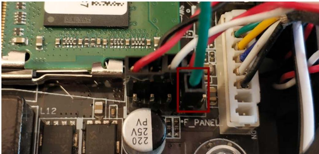
**Рисунок 34 - Подсоединение кабеля Reset к материнской плате СВТ**
