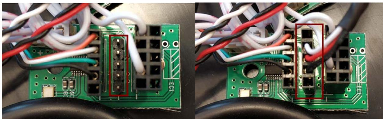
**Рисунок 32 - Подсоединение кабеля USB от платы контроллера «Аккорд-GXM2 v.S» к свободному пятиконтактному разъему внутреннего разветвителя и ориентация установки разъема (при отсутствии свободных разъемов USB на материнской плате)**
