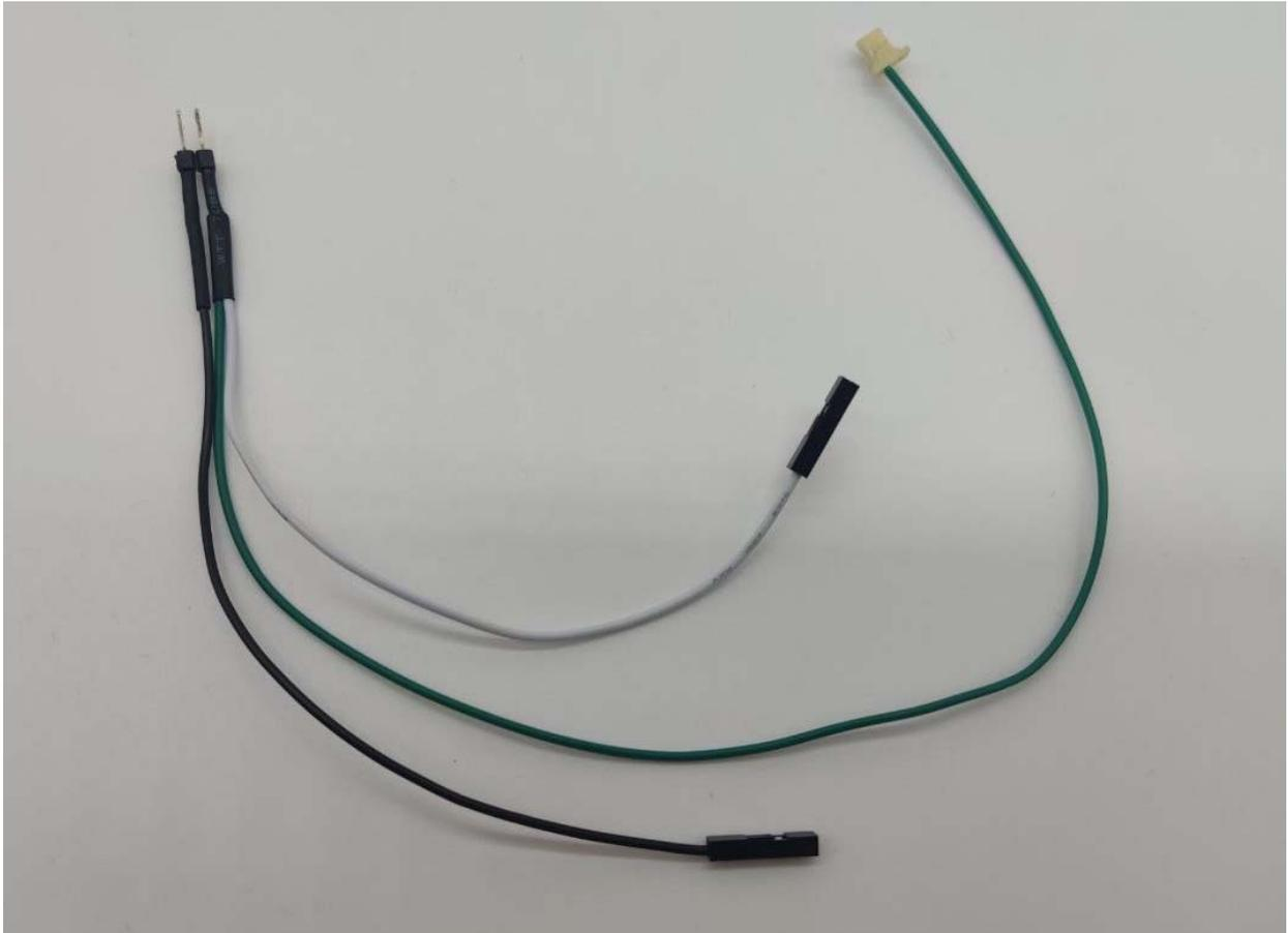
**Рисунок 21 - Кабель для подключения кнопки Reset, расположенной на корпусе системного блока**
