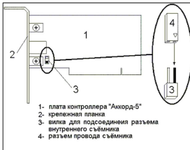
**Рисунок 23 - Общая схема подсоединения съёмника информации к плате контроллера**
