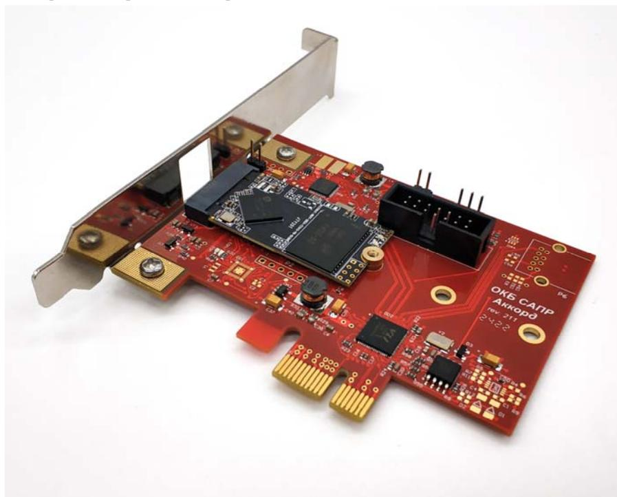
Рисунок 11 – Плата контроллера Аккорд-GXM2 v.P
