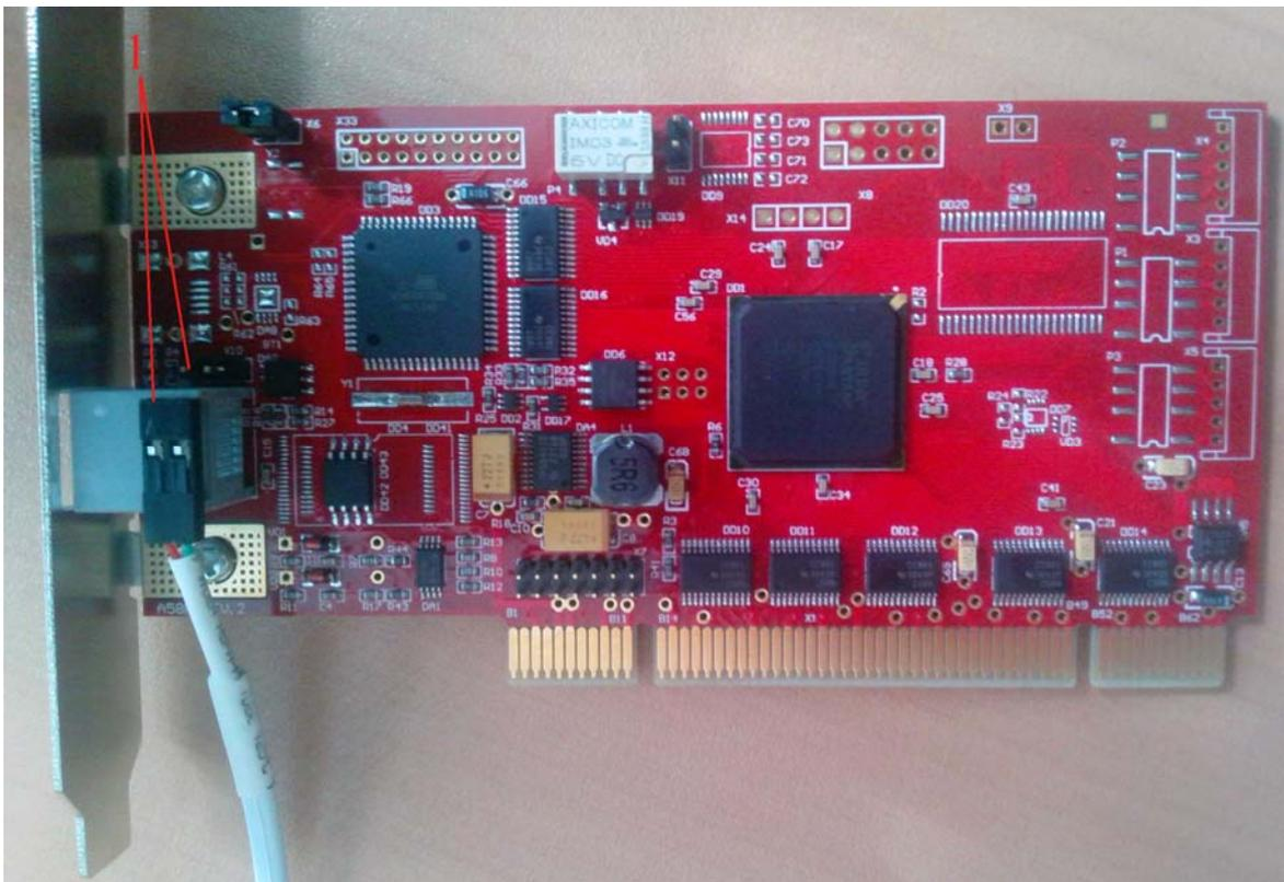
**Рисунок 25 - Подсоединение съемника информации к плате контроллера Аккорд-5.5**
