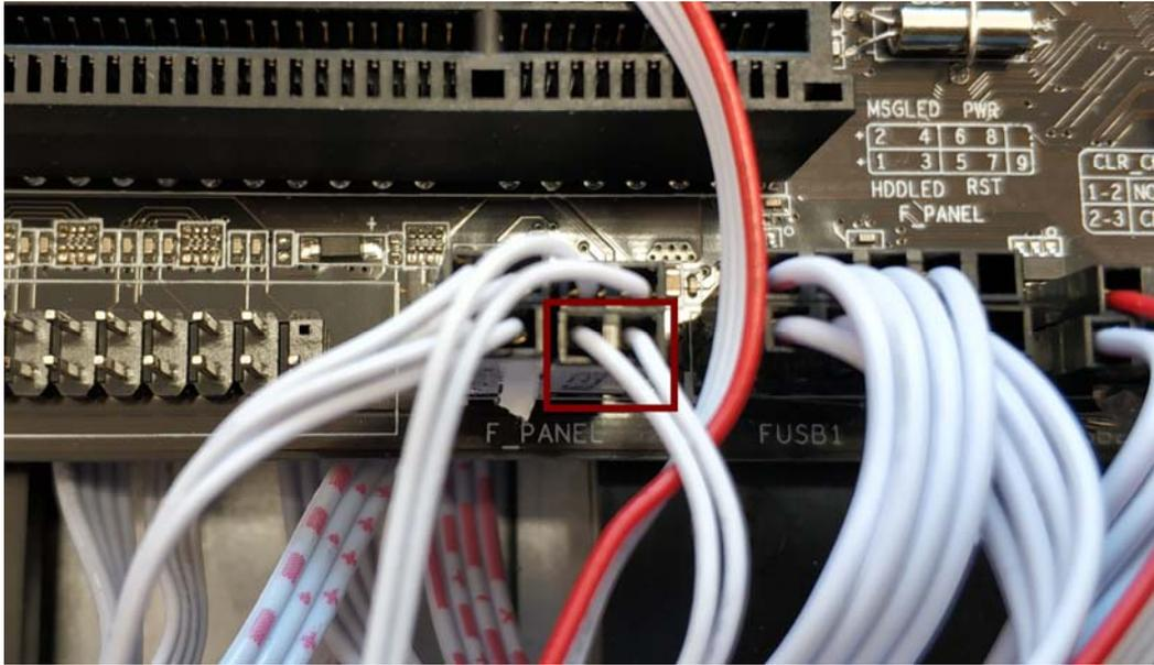
**Рисунок 35 - Место подсоединения кабеля для вывода на кнопку Reset, размещенную на корпусе системного блока**
