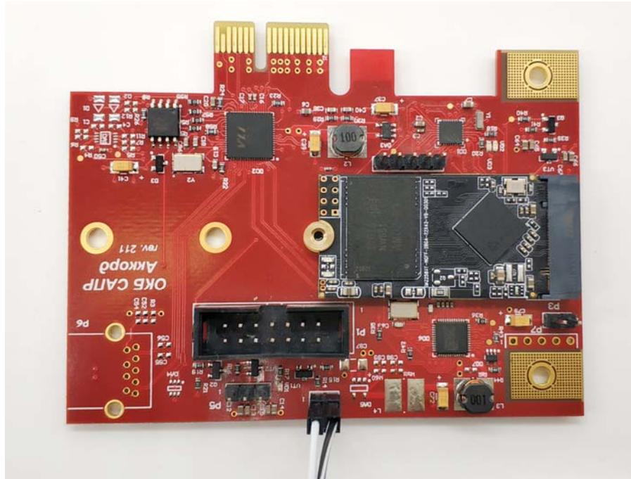
**Рисунок 12 – Подсоединение кабеля Reset к контроллеру Аккорд-GXM2 v.P. Вид сверху**
