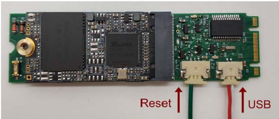
**Рисунок 14 - Плата контроллера Аккорд-GXM2 v.S**
