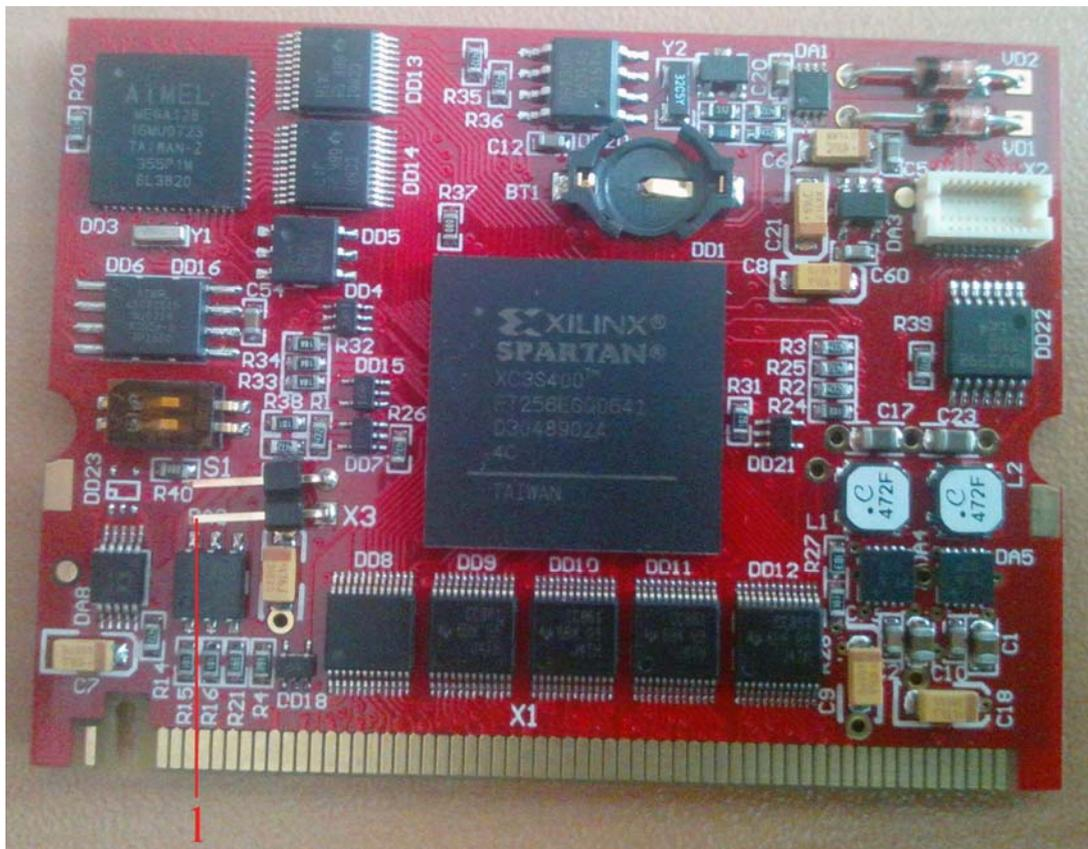
**Рисунок 28 - Подсоединение съемника информации к плате контроллера Аккорд-5.5MP**
