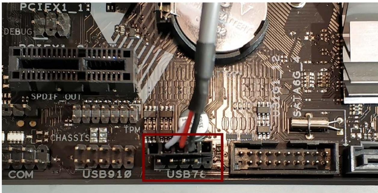
**Рисунок 31 - Пример подсоединения кабеля USB к материнской плате СВТ**
