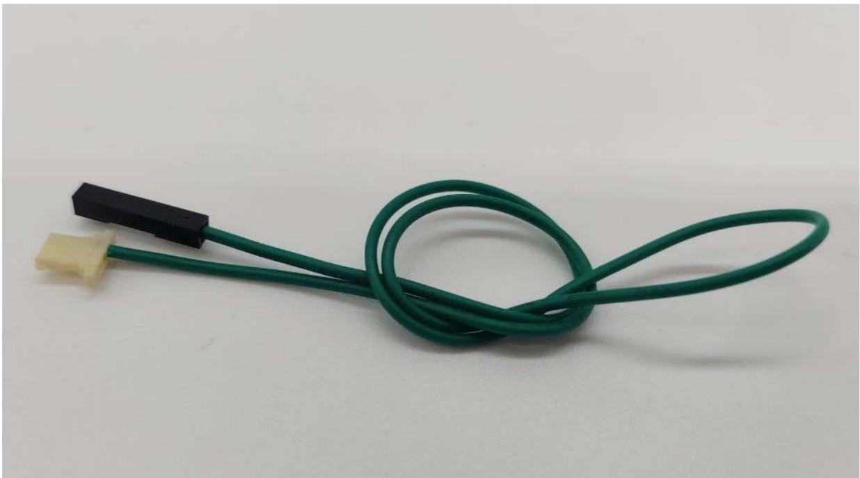
**Рисунок 20 - Кабель для подключения к коннектору Reset на материнской плате**
