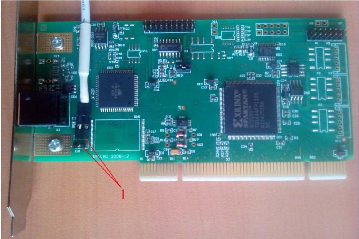
**Рисунок 24 - Подсоединение съемника информации к плате контроллера Аккорд-5МХ**
