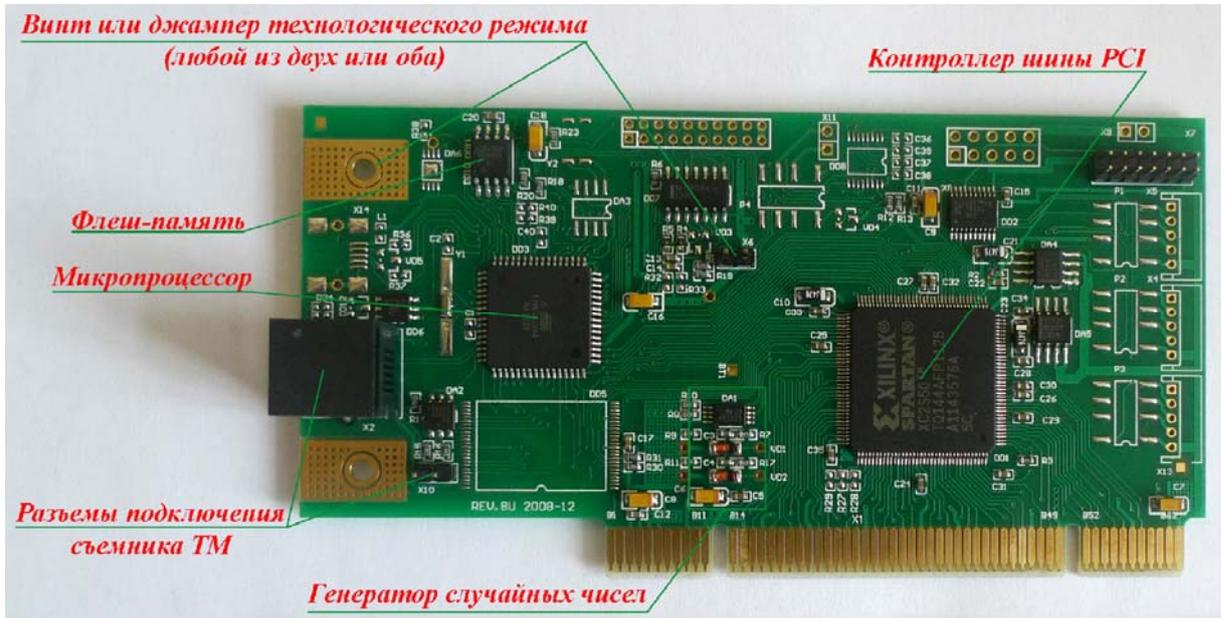
**Рисунок 1 - Плата контроллера Аккорд-5МХ**
