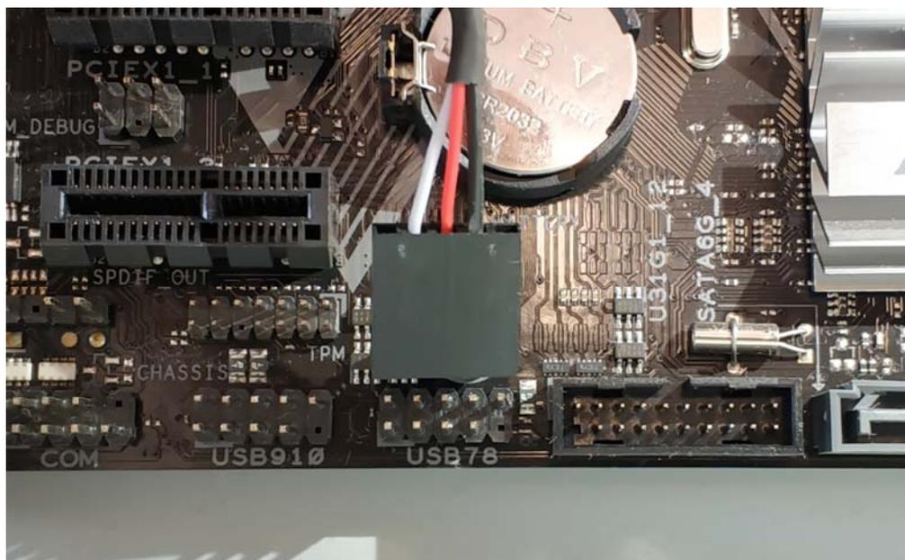
**Рисунок 30 – Пример подсоединения кабеля USB к материнской плате СВТ**
