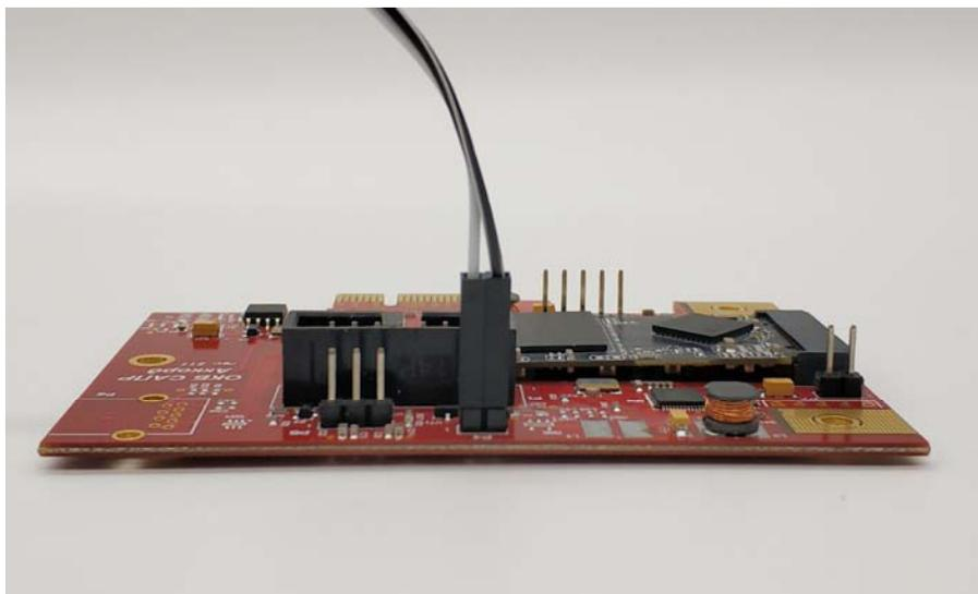
**Рисунок 13 - Подсоединение кабеля Reset к контроллеру Аккорд-GXM2 v.P. Вид сбоку**
