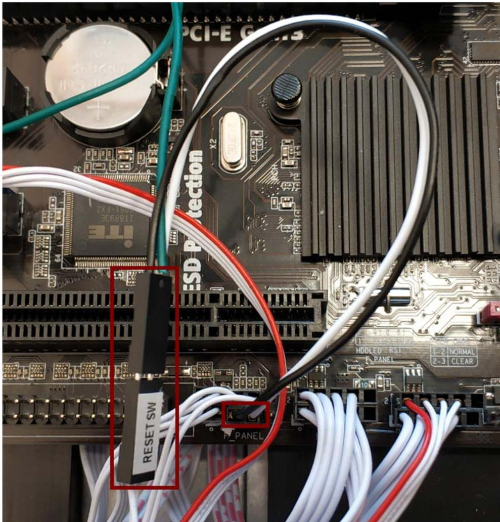
**Рисунок 36 - Подсоединение кабеля Reset**
