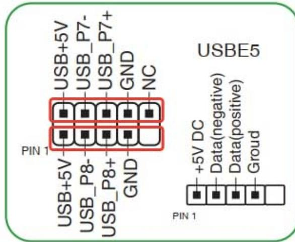
**Рисунок 33 – Схема расположения разъемов USB на материнской плате**
