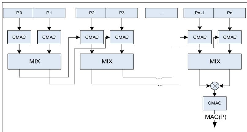
Кроме всего прочего, можно распараллелить вычисление имитовставки, применяя СМАС к двум независимым блокам шифротекста с последующим перемешиванием полученных промежуточных результатов (MIX). На рисунке выше представлена схема предлагаемого решения.
