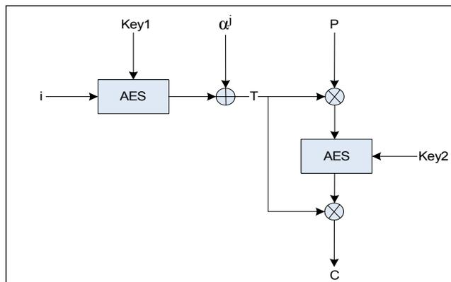
Режим предполагает использование пары ключей, в качестве  $i$  используется номер сектора,  $j$  – номер 128-битного блока внутри сектора (не больше  $2^{20}$ ),  $\alpha$  – примитивный элемент поля  $GF(2^{128})$ . Также в стандарте описывается техника Ciphertext Stealing (CTS), которая заключается в особой обработке двух последних блоков открытого текста, размер которого не кратен 128 битам.
