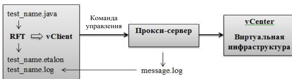
Рис. 1. Этап 1: схема получения ожидаемого результата выполнения теста (test_name.etalon) и log-файла (test_name.log)
