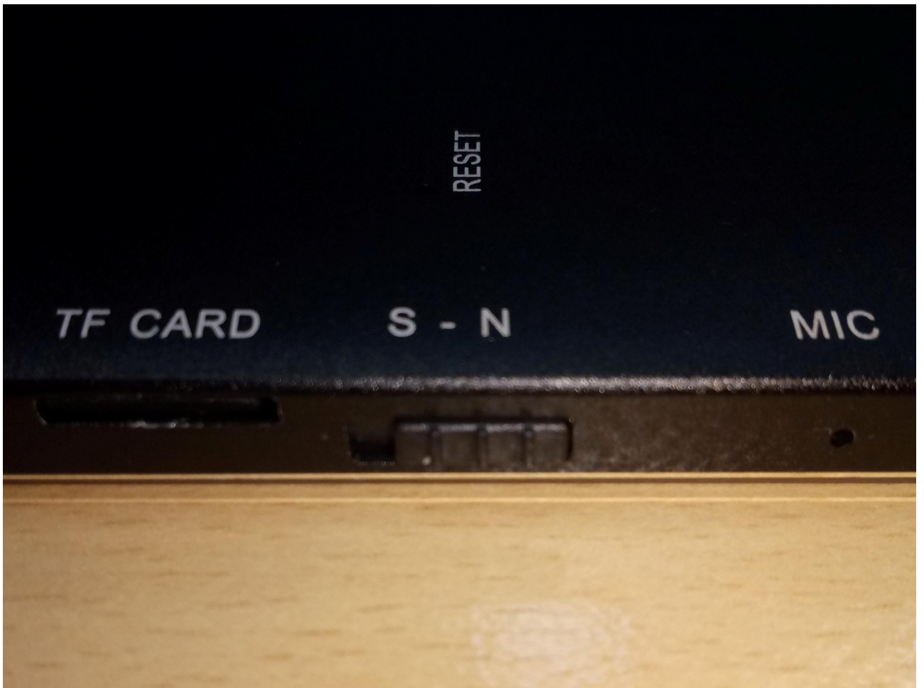
Рисунок 1 – Аппаратный переключатель планшетного компьютера «TrusTPad»
