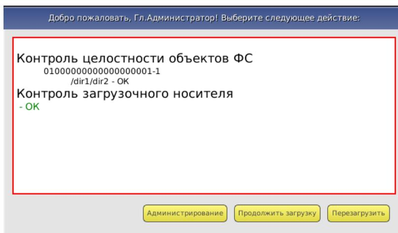
**Рисунок 4 – Окно контроля целостности в случае успешного прохождения контроля**
