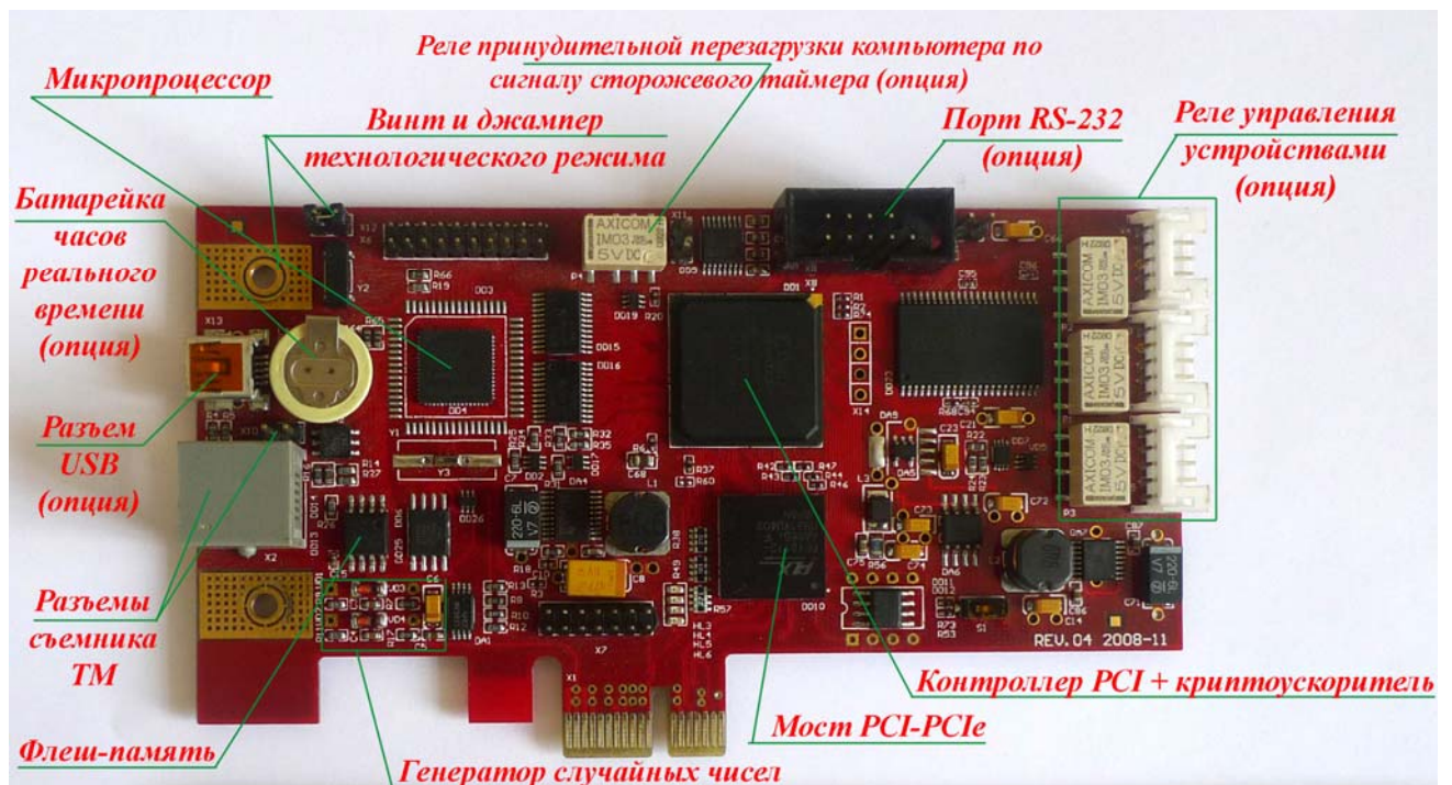
Рисунок 3 - Плата контроллера «Аккорд-5.5е»
