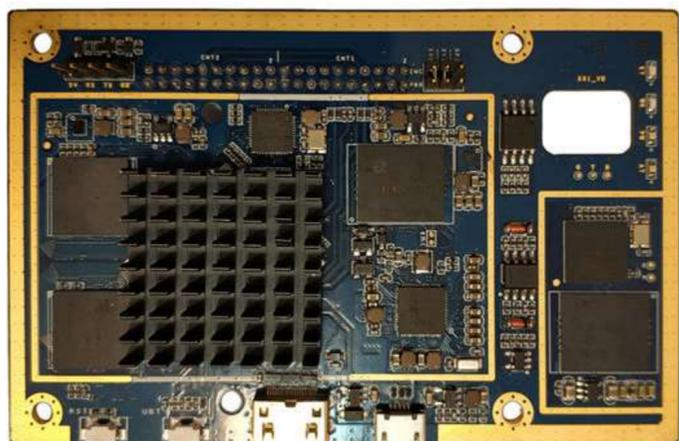
Док-станция предназначена для того, чтобы корректно подключить m-TrusT к тому или иному конкретному элементу КИИ, поэтому её конструктивное решение и набор портов могут существенно различаться, ведь такими элементами могут быть самые разные объекты – от локомотивов до банкоматов, от газовых счетчиков до терминалов управления АЭС.
